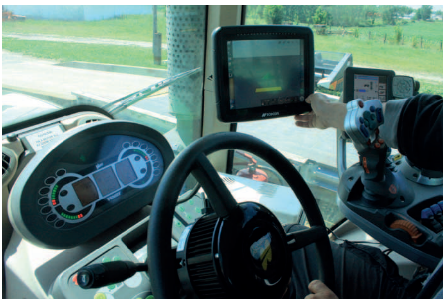
1. kép Az X30 monitor és az AES-25 elektromotoros kormánymű a Fendt 933 traktorban
