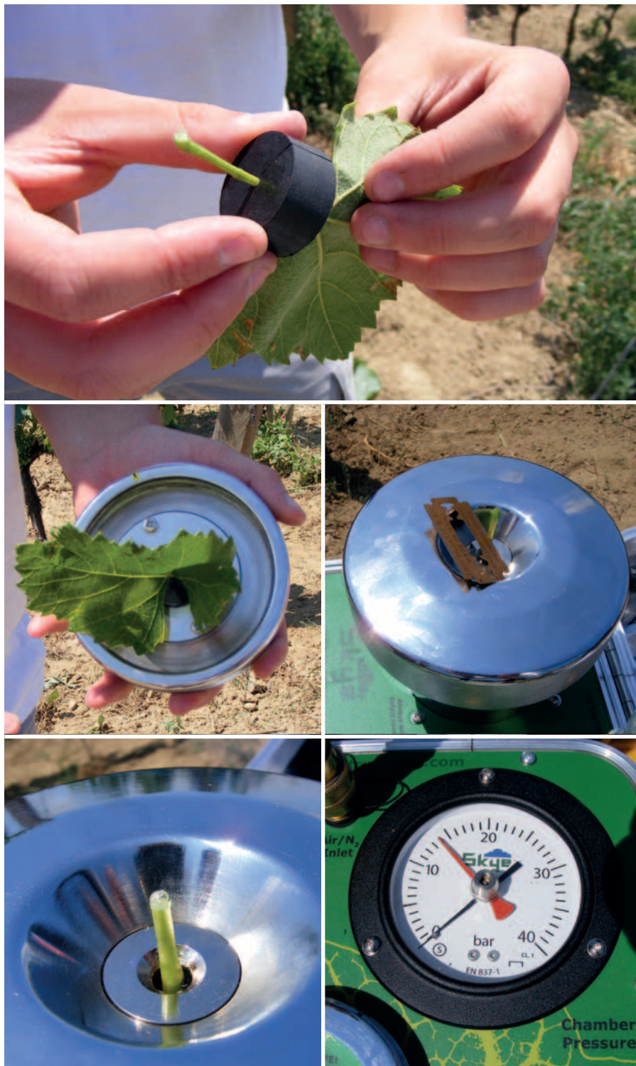
1. kép Vízpontenciál mérés a Scholander-féle nyomáskamrával
