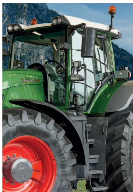
5. kép A munkagépre való jobb rálátását a megnagyobbított mellső és oldalszélvédők, a megszélesített vezetőfülke ajtó, valamint az abroncsméretre igazítható alsó lépcsőfok állíthatósága szolgálja.
