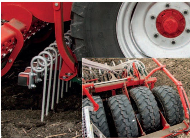
4. kép A tárcsák, illetve a kapák által megmunkált talajt a lépcsőzetes elrendezésű, offset hengerson, illetve a mögötte elhelyezkedő pálcasor egyengeti és tömöríti
