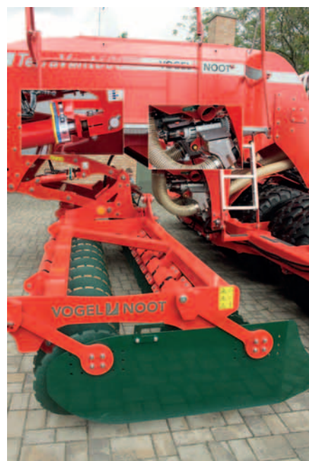
2. kép A TerraVant tárcsás magágykészítő egysége. A kisképek mélységhatárolás klipszekkel történő megoldását, illetve az elektromos magadagolót emelik ki.
