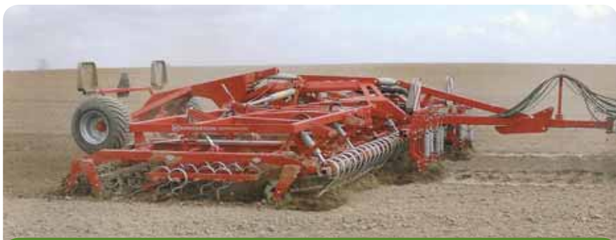
Precíziós magágykészítő gép nyomlazitóval
