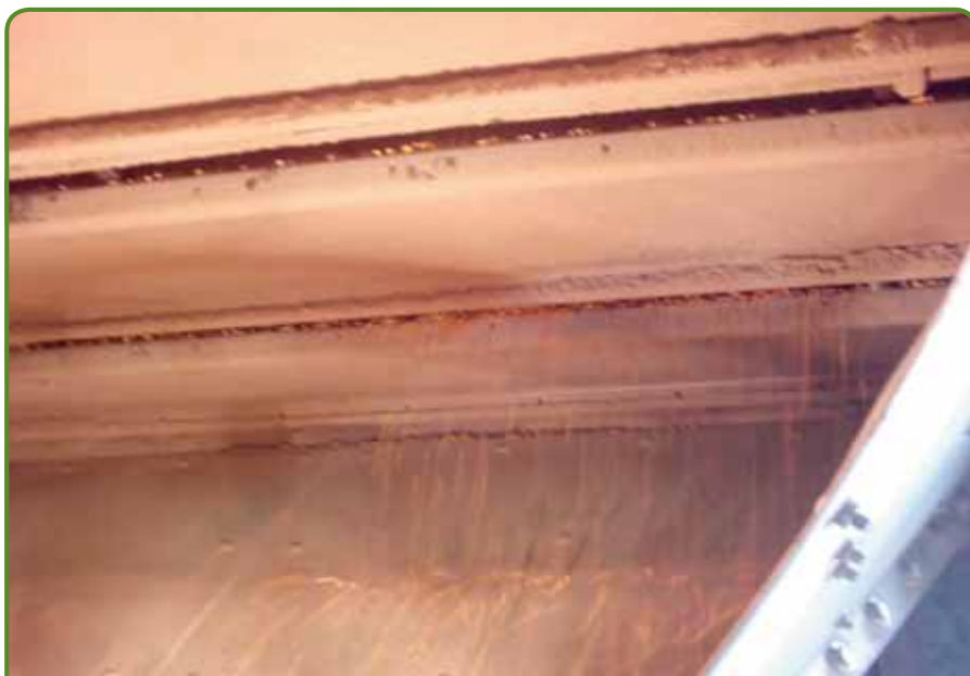
1. kép Jól látható a folyamatos „csorgás” az ürítőszerkezetnél, ami a 4. ábra 2. és 3. oszlopában mutató alacsonyabb maghőmérsékletet, a kiadagolt terményben pedig jelentős nedvességtartalom-eltérést okozott.
