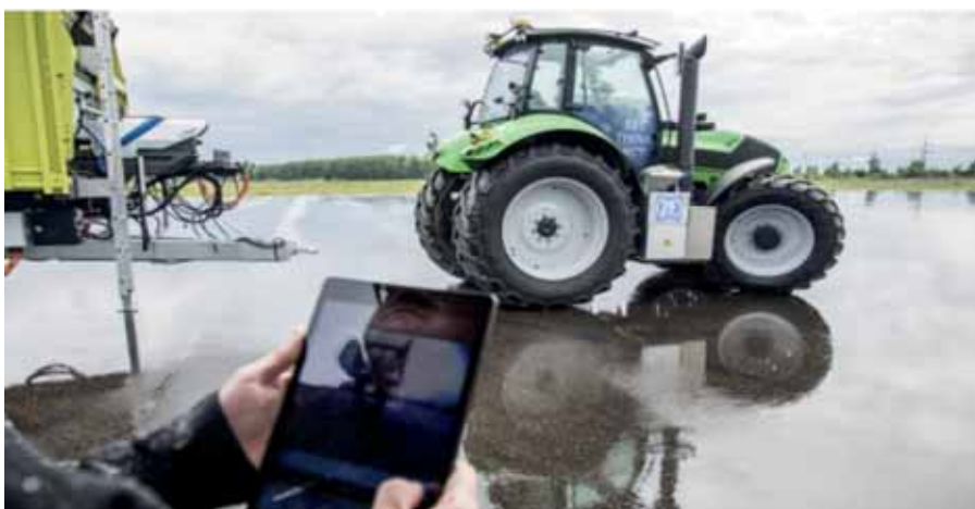
11. ábra Automatikus pótkocsi kapcsolás (Hat kamerás helyzetmeghatározó rendszer)
