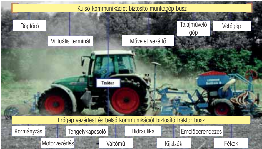
3. ábra Traktor-munkagép kommunikáció ISOBUS ISO 11783
