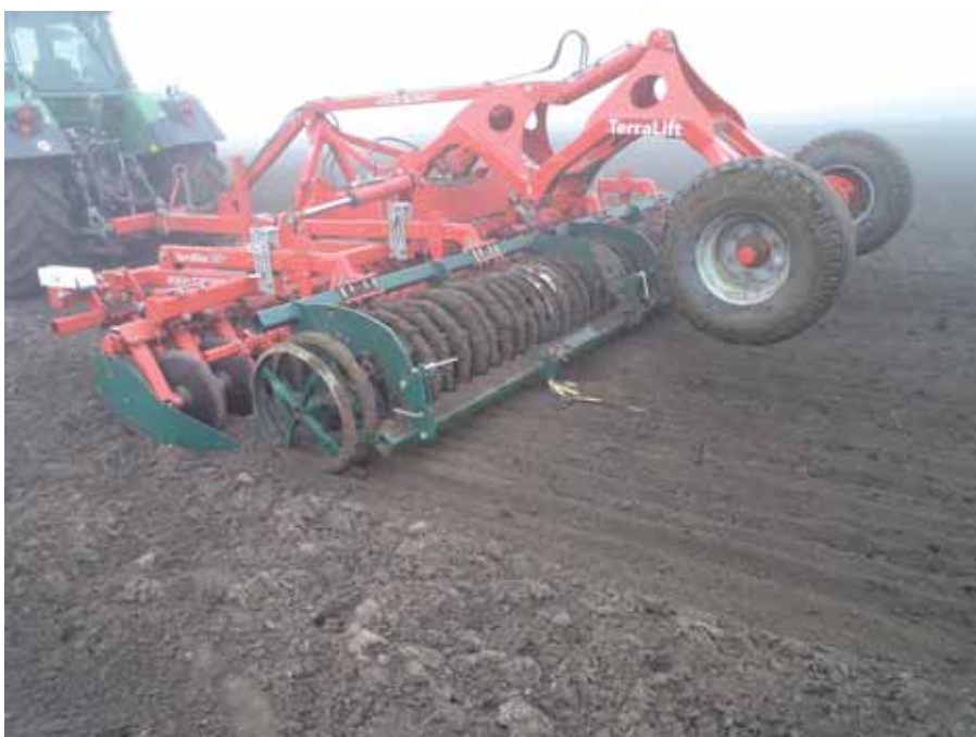
2. kép Sekély siktárcsás szántáselmunkálás csapadékhiányos télen. Az ékgyűrűs henger a Campbell hengerhez hasonló felszínt alakít ki, Tabajd, 2014. január
