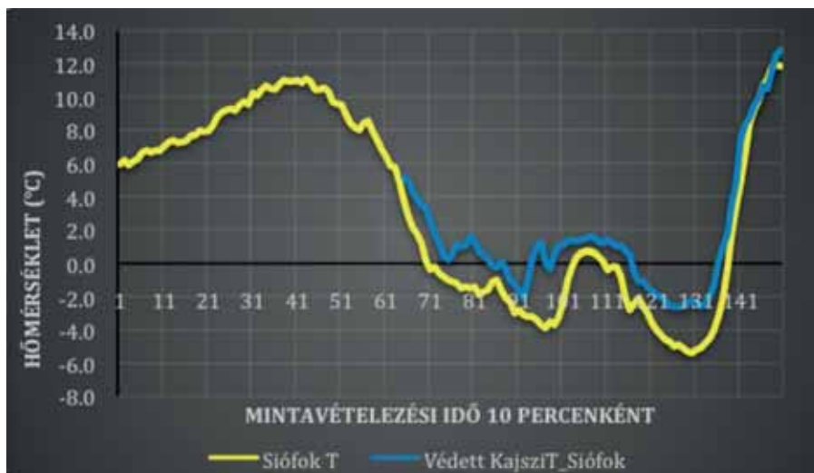
2. ábra A paraffin gyertyával védett intenzív kajszi ültetvény, valamint a kontroll terület hőmérsékletének alakulása
