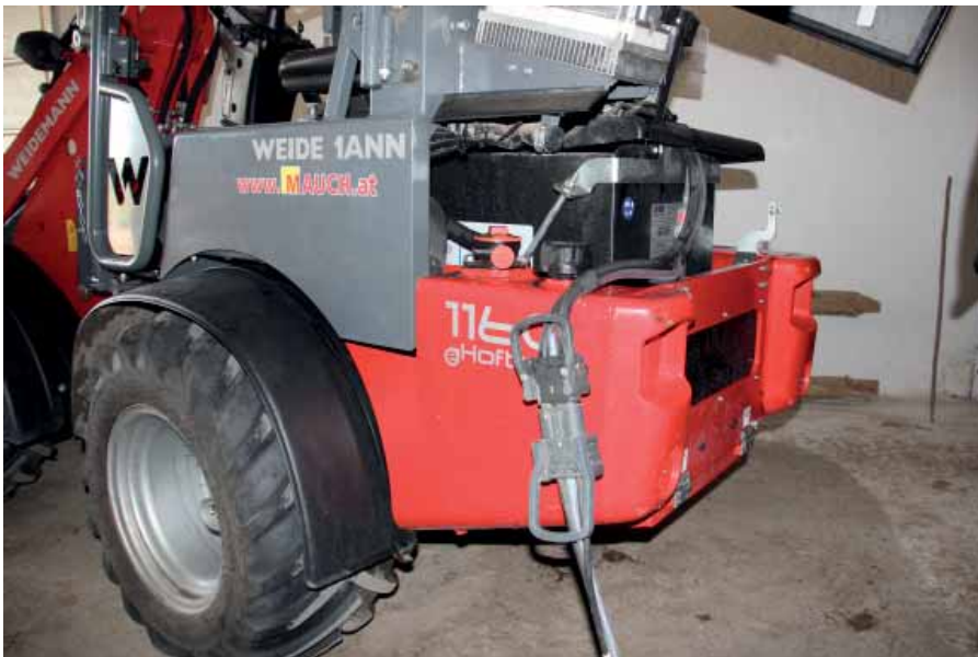
A speciális csatlakozó, mely az áramellátást biztosítja. Ebbe integrálták a 3 töltésenként pótolandó desztillált vizes vezetékét is, melynek szivattyúja a szivargyűjtőből aktiválható
