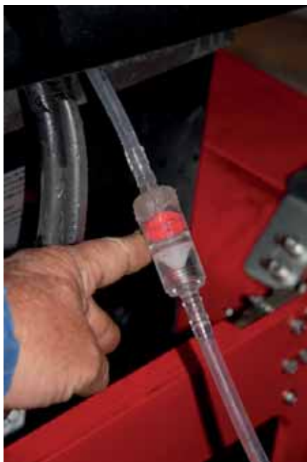
A desztillált víz töltésének folyamata könnyen kontrollálható a kis piros kerék forgásából
