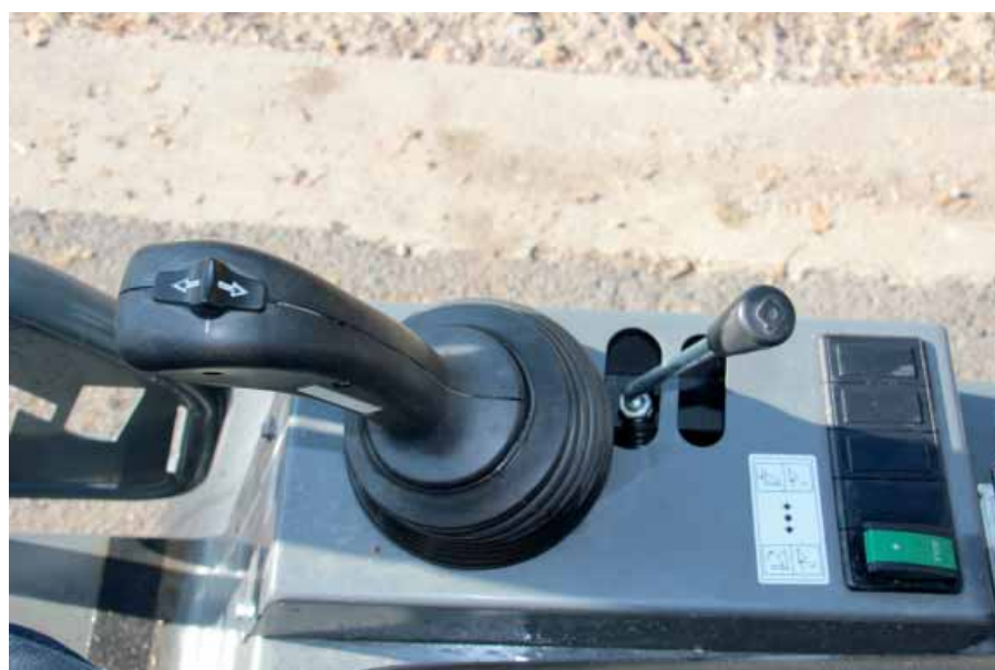
Az eHoftrac kezelése és előre-hátra való mozgásának irányítása egyszerűen, a joystickról és egy másik karról vezérelhető, csak úgy, mint egy hagyományos rakodógép esetében
