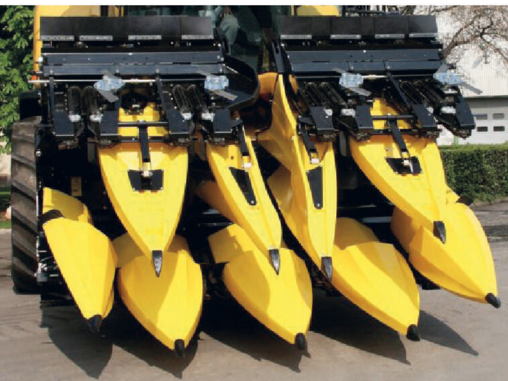
6. kép Oros Cornado adapter szállítási helyzetben
