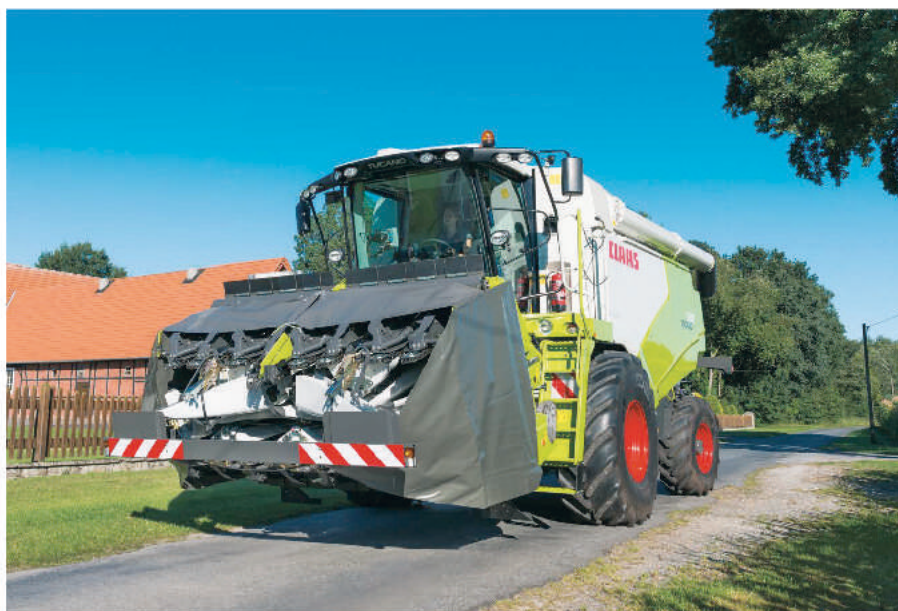
2. kép A CorioConspeed adapter szállítási helyzetben
