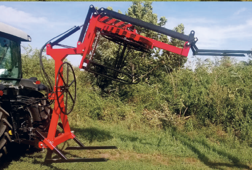
Az Auditer FB-1000-R fóliabegyűjtő hidraulikus rakodóvillája működés közben
