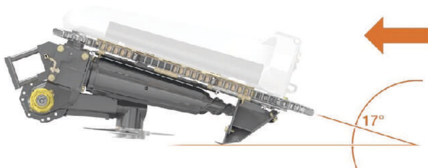
1. kép Az adapterek talajjal bezárt szöge 17°
