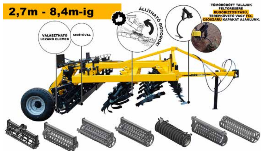
2. ábra A Busa FKM Forgókapás Magágykészítő felépítése
