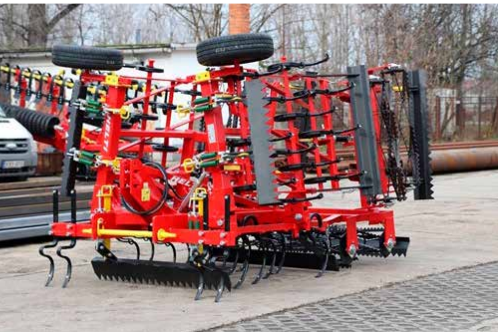
5. kép A Helti legnépszerűbb, négy kapasorral felszerelt magágykészítője
