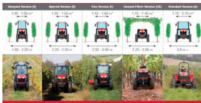
Keskeny traktorok szőlőültetvény műveléséhez
