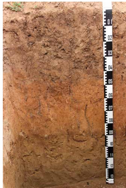
4. kép Talajszelvény-feltárás a telepítés előtt
