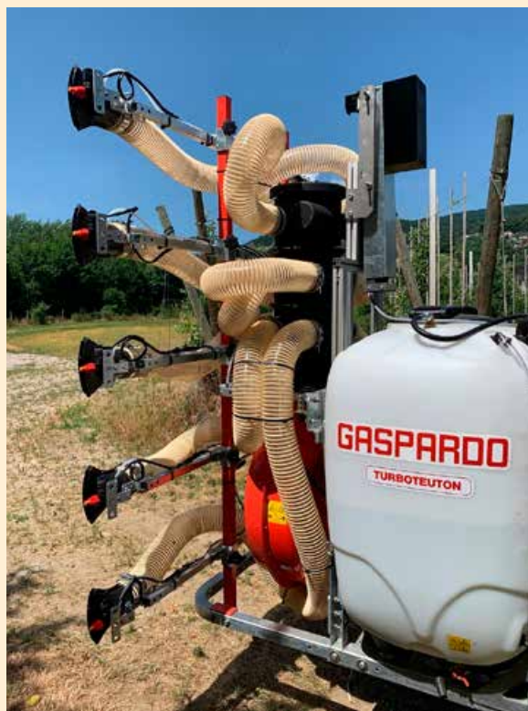
3. kép A University of Maribor és az AE-ROBO-NET valamint a CREA és a Maschio Gaspardo közös kutatásának eredménye olyan permetező amely LiDAR alapján végez a változtatható dóziséű növényvédőszer-kijuttatást (Fotó: Dr. Jurij Rakun)
