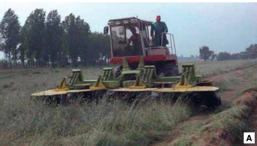
2. kép Mellő függesztésű (A) és vontatott (B), dobos kaszакonstrukció, paralelogramma egyenkénti forgórész felfüggesztéssel
