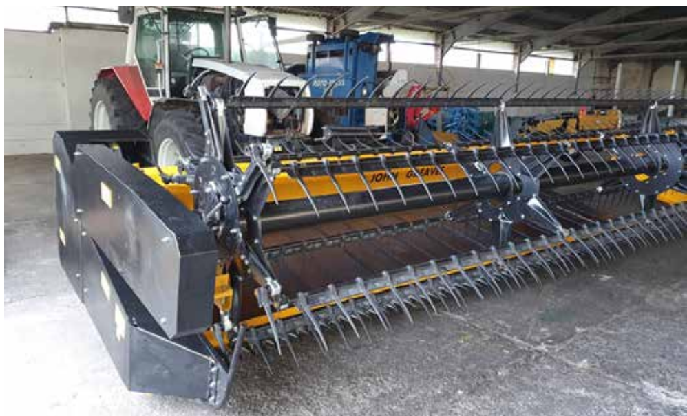
9. kép Mellső függesztésű rendrevágó, mellső függesztővel szerelt traktoron
