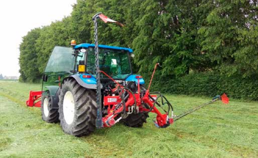
5. kép Az alternáló vágószerkezetű kaszák is szerelhetők, illetve üzemeltethetők gépkombinációkban
