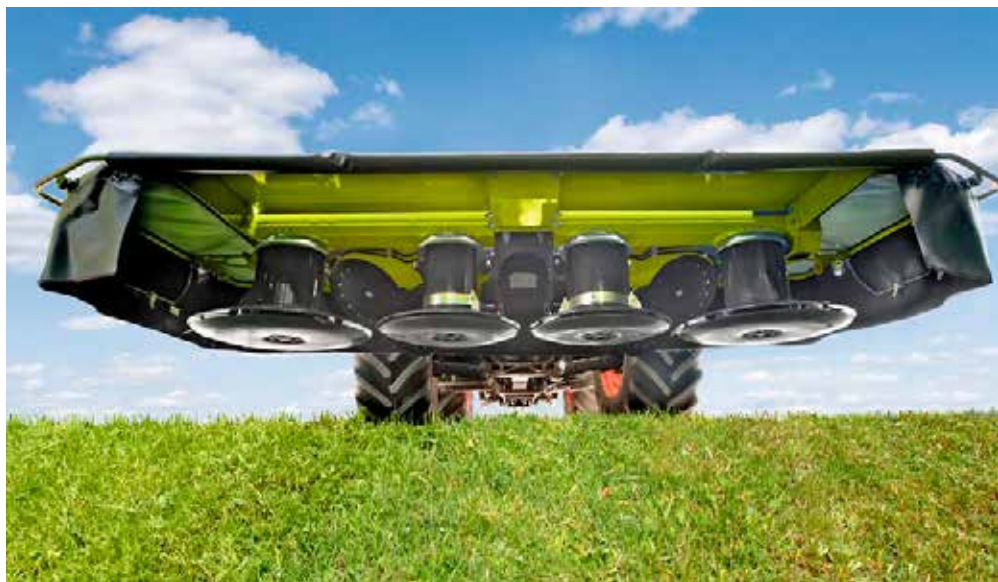
1. kép Négy forgórészes, dobos rotációs kaszакonstrukció
