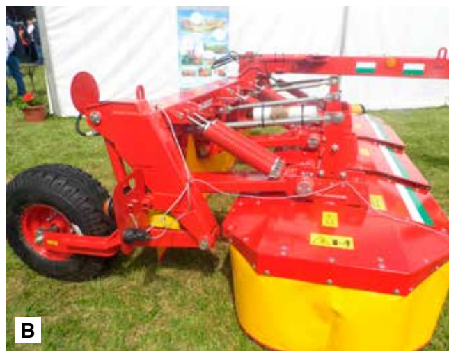
2. kép Mellő függesztésű (A) és vontatott (B), dobos kaszакonstrukció, paralelogramma egyenkénti forgórész felfüggesztéssel
