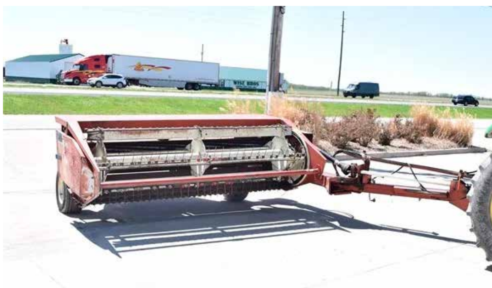
7. kép Vontatott, alternáló kasza vezérelt ujjas motollával
