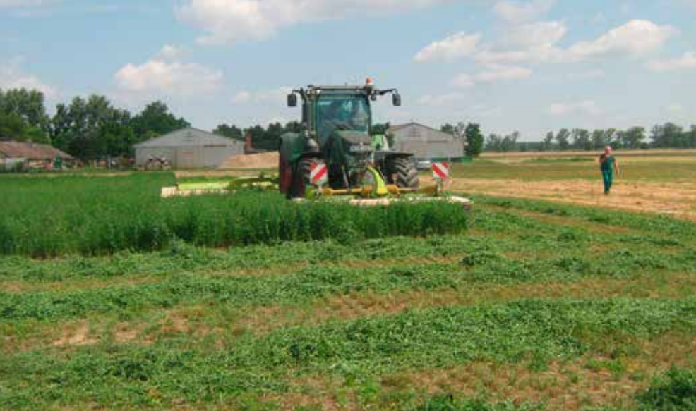
3. kép Mellső- és hátsó függesztésű tárcsás, rotációs kaszákombináció lucernakaszálásban
