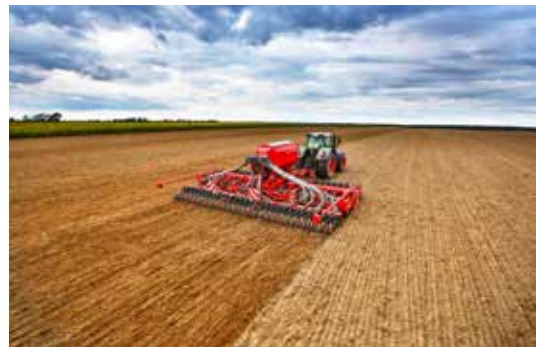
A gumikerekes henger „autópályát” képez a TurboDisc vetőcsoroszlyának
