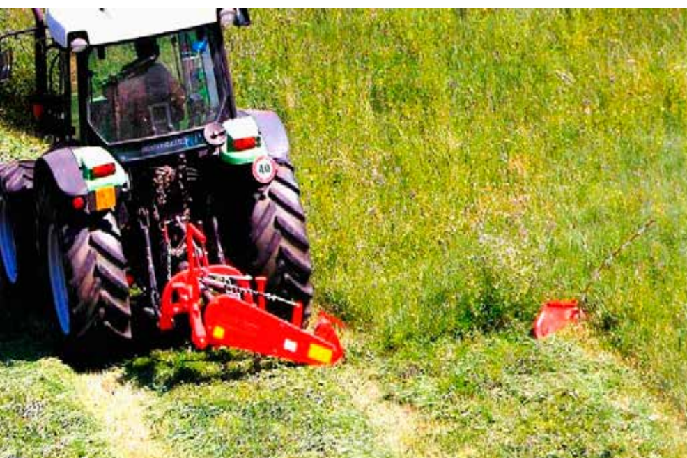
6. kép Kettős löketű, két mozgópengés, hátul függesztett konstrukció gyepek kaszálásban
