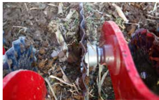
A hullámos tárcsák no-till-ben vetőmagágyat képeznek a TurboDisc vetőcsoroszlyának
