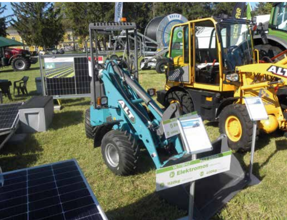
5. kép 12 kW teljesítményű, villamos üzemű „telepi mindenés”
