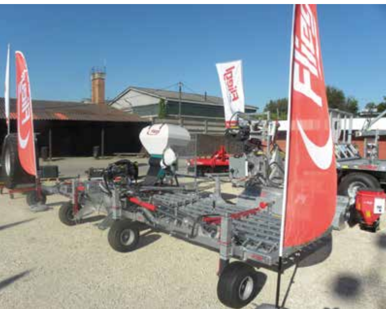
3. kép A Fliegl 6 m munkaszélességű, aprómag vetőegységgel felszerelt, szakaszolt pálcás gyomfűsűje
