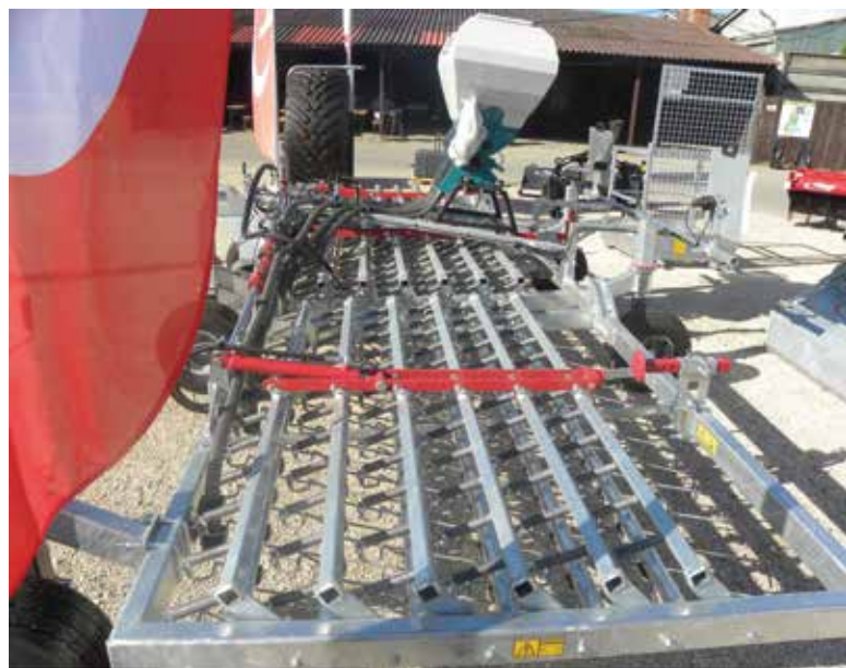
3. kép A Fliegl 6 m munkaszélességű, aprómag vetőegységgel felszerelt, szakaszolt pálcás gyomfűsűje
