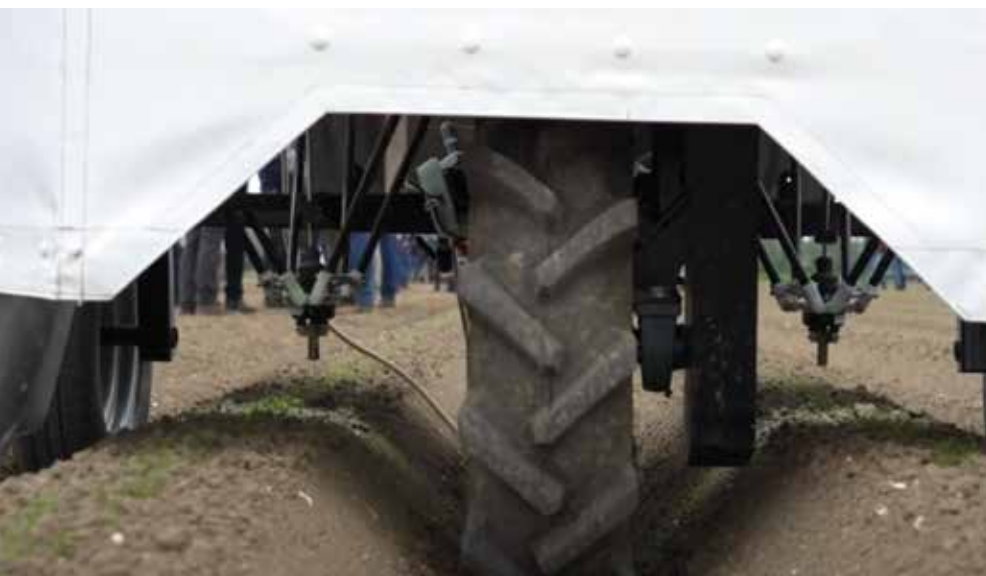
7. kép A Quirky egyszerre két sor gyommentesítését végzi
